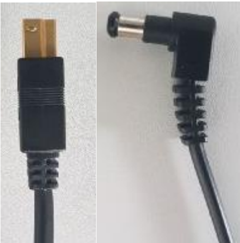
Abbildung 2 USB-Kabel 3.1 u. Strom-Kabel Scanner
