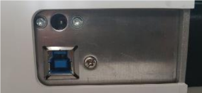
Abbildung 3 Anschluss Scanner USB u. Strom
