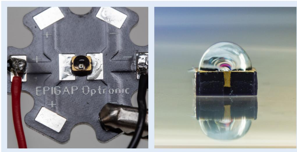
Abb. 2) Ergebnis einer mittels Mikrotropfen-Dosiersystem hergestellten Domlinse auf einer InGaN-CoB-LED mit dem im Projekt entwickelten Polyurethan „resPUR-OT“.
