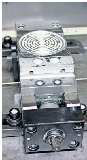
Exakt gefräst sind die einzelnen Bahnen des Kugellabyrinths, das die Studenten entworfen haben.
