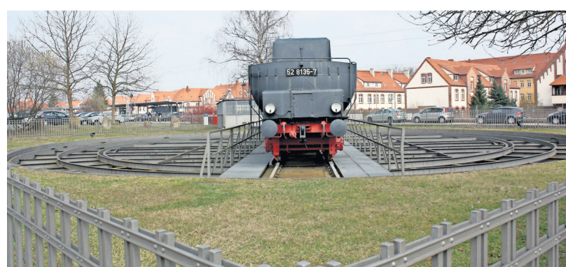
Die historische und denkmalgeschützte Drehscheibe, auf der die Lok der Baureihe 52 positioniert ist, hat einen Durchmesser von 26 Metern.
