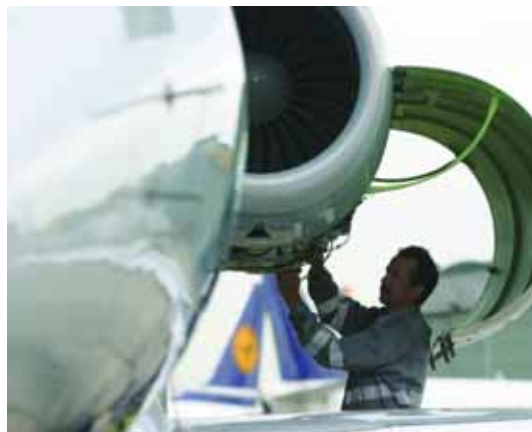
LBAS-Mitarbeiter bei der Wartung des Triebwerks eines Bombardier Learjets
