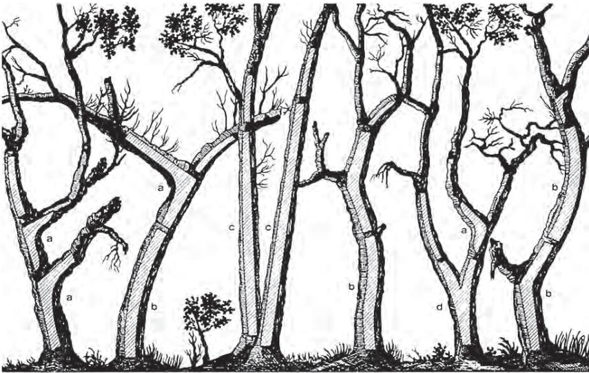
Abbildung 4: Bauteilgewinnung für den Schiffbau [8]
