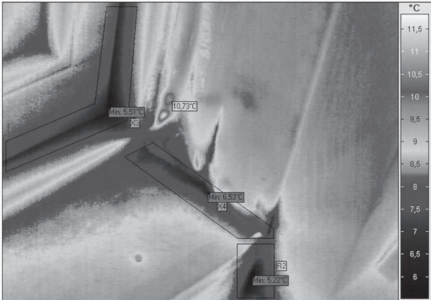
Abbildung 9: Thermographie von innen bei Unterdruck
