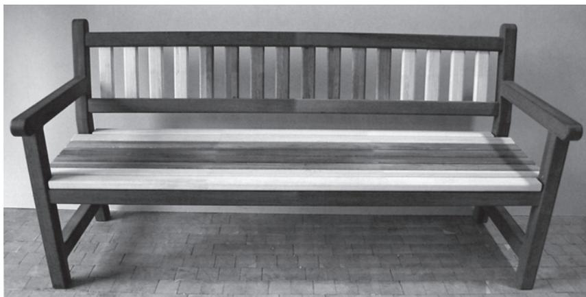
*Abbildung 4: Thermoholz – Gartenbank zum Vergleich von Holzeigenschaften im Praxistest. Verbaut wurde Eiche, Thermoholz aus Eiche und Meranti. Die Farbunterschiede resultieren aus den Holzarten sowie verschiedene Behandlungsvarianten bei der thermischen Veredlung.*
