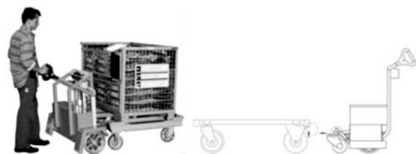
Abb. 4: Anwendungsbeispiel und Funktionsweise einer Andockstation
