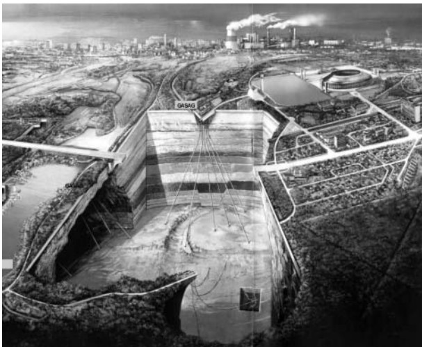
Abb. 1: Erdgas-Untertagespeicher mit Tiefbohrungen für Förder sonden
