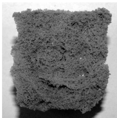
Abb. 4: Sinterkeramikschaumstoff 51 nach dem Brennprozess
