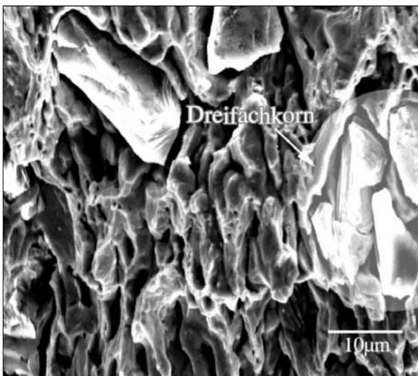
Abb. 5: REM Aufnahme der Diamant-Metall-Verbundfolien – mit Cluster von drei Diamanten
