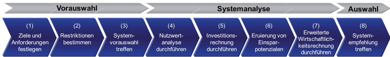
Abb. 7: Vorgehensweise bei der Auswahl eines Identifikationssystems
