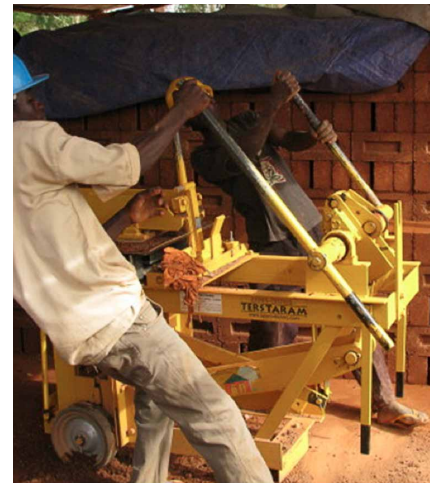
Abb. 5) Togoische Bauarbeiter bei der Bedienung einer manuellen Lehmsteinpresse vom Typ ApproTechno Terstaram [DAZ e.V. 2013]
