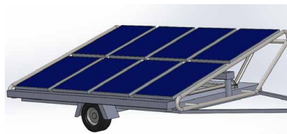
Abb. 7) CAD-Modell der mobilen Photovoltaikanlage
