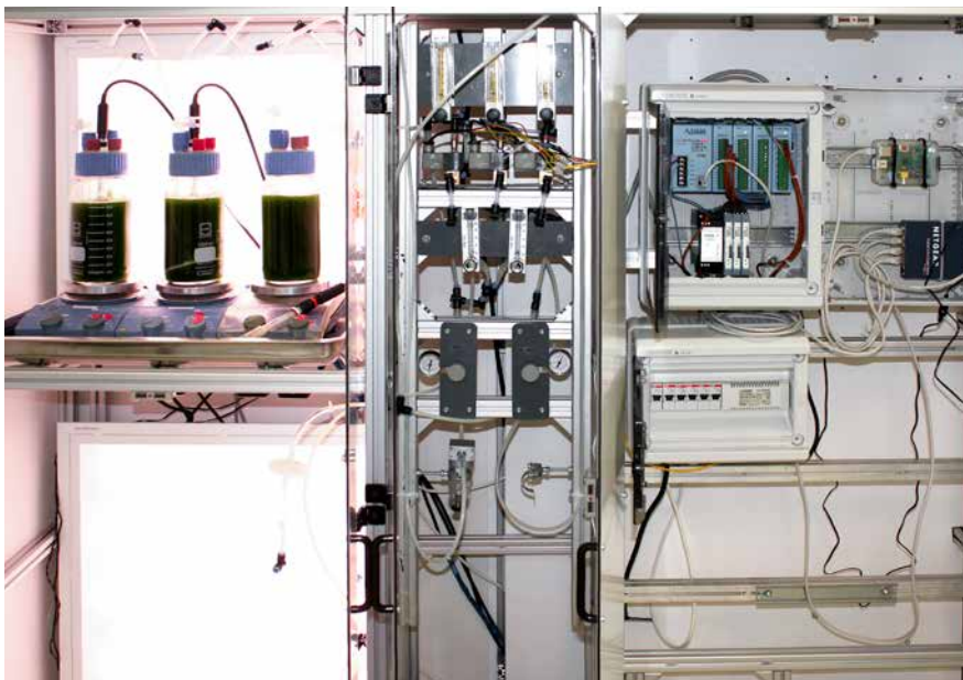
Abb. 4) Versuchsaufbau des Automatisierungssystems. Im Reaktorsystem (links) sind drei Bioreaktoren in 1l-Schottflaschen auf Heizplatten zu sehen. In den luftdicht modifizierten Deckeln befinden sich die Anschlüsse für Druckluft und CO 2 sowie die pH-Sensoren. Das Belüftungssystem (Mitte) umfasst die CO 2 -Begasung mit steuerbaren Magnetventilen. Im Steuerungssystem (rechts) sind der Raspberry Pi sowie der ADAM-Messwandler mit den verbauten Modulen zu erkennen.
