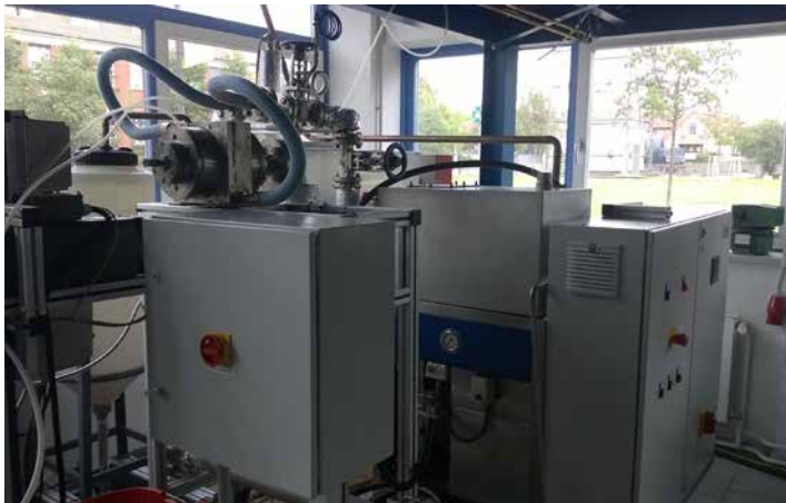
Abb. 3) Turbinenversuchsstand im Technikum für regenerative Energietechnik. Links: Realer Versuchsstand mit dem Tesla-Turbinen-Prototyp. Rechts: 3D-Modell des Versuchsstandes.
