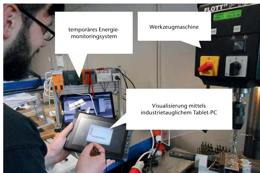
Abb. 2) Erfassung energetischer Daten zur Unterstützung der Wartung einer Werkzeugmaschine
