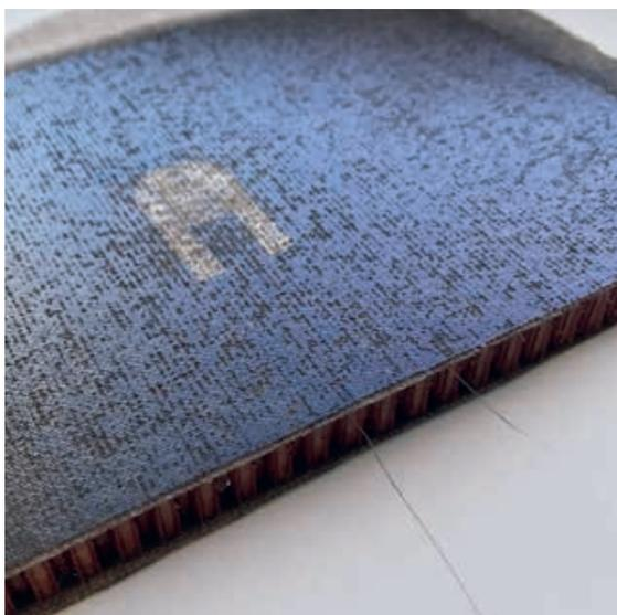
Abb. 1 Leichtbau-Sandwich mit piezoelektrischem Sensor
