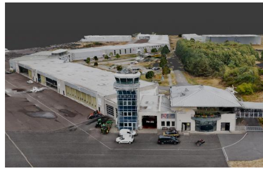
Abbildung 31: 3D-Modell des Flugplatz Schönhagen aus Fotogrammetrie (Quelle: TU Ilmenau)
