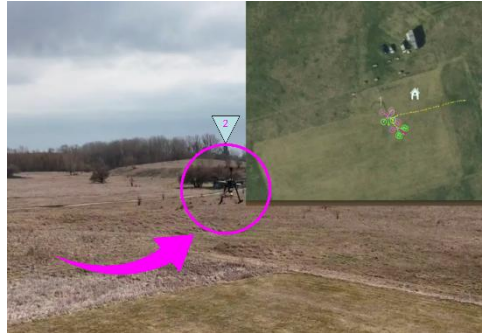
Abbildung 44: Ausweichmanöver durchgeführt und Abstand zur anderen Drohne wieder vergrößert
