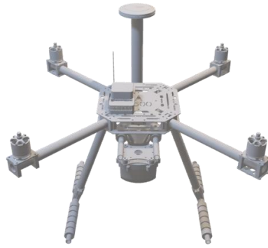
Abbildung 34: 3D-Modell der Multikopterdrohne X500 mit Kamera für die Verwendung in einer 3D-Simulation mit Live-Flugdaten
