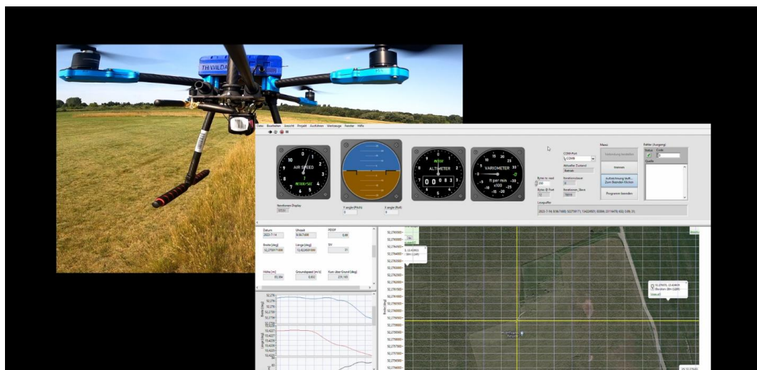
Abbildung 1: Testflug einer Drohne, Einstellung des Flightcontrollers, Testen der eigenen Groundstation-Software zur Überprüfung der Telemetrie-Verbindung und Anzeige sowie Aufzeichnung von Telemetriedaten
