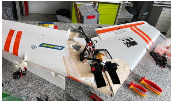
Abbildung 47: Erhebliche strukturelle Schäden infolge des Aufpralls
