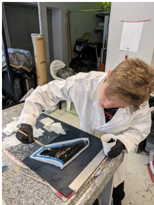
Abbildung 10: Fertigung der Winglets der Nurflügel-Drohne MANTA-X
