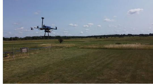
Abbildung 3: Testflüge zur Datengewinnung und Einstellung der Flightcontroller
