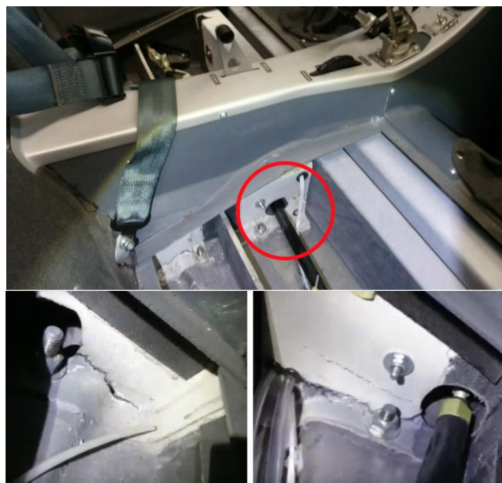
Abbildung 19: Riss am Spant unter dem Sitz des Forschungsflugzeugs JULIA
