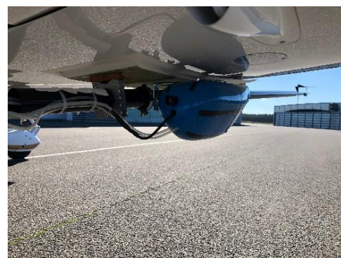
Abbildung 41: Messeinheit und Spannungsversorgung der Luftdatensonde DIFG-05
