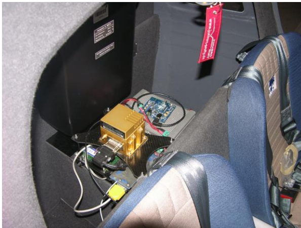
Abbildung 16: Eingebaute Messanlage MACS im Forschungsflugzeug JULIA
