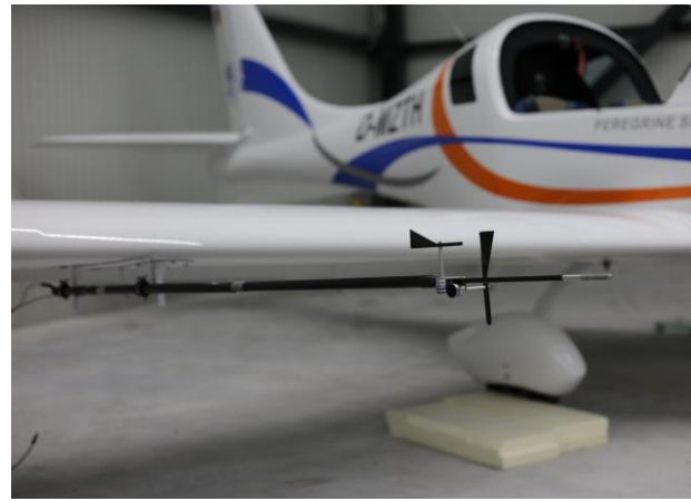
Abbildung 16: Eingebaute Messanlage MACS im Forschungsflugzeug JULIA
