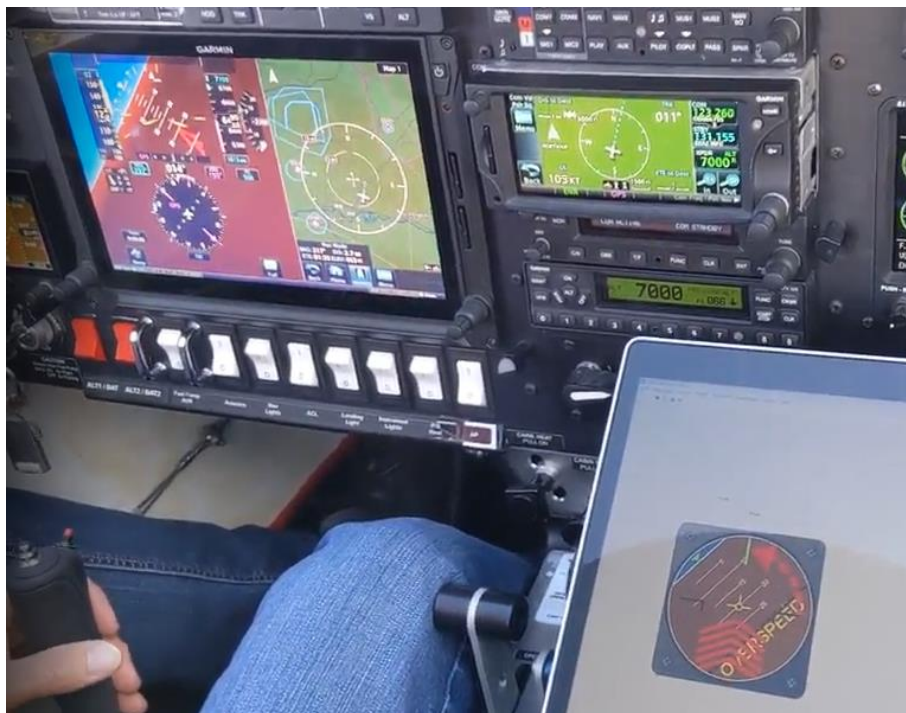
Abbildung 44: Flugtests des VIGA-Systems (Laptop-Bildschirm) in der Aquila A212T, Szenario „Overspeed“ (Trigger: maximale Fluggeschwindigkeit)
