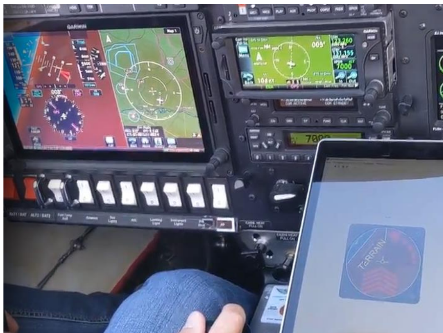
Abbildung 42: Flugtests des VIGA-Systems (Laptop-Bildschirm) in der Aquila A212T, Szenario: „Terrain“ (Kollisionsvermeidung mit dem „virtuellen Boden“; Trigger: maximales Lastvielfaches)
