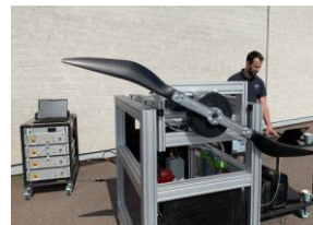
BILD 2. Bodenprüfstand für E-Antriebe bis ca. 80 kW
