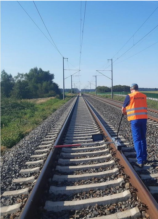
Schienenrauheitsmessgerät im Einsatz
