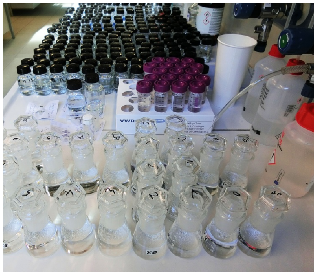
Auslaugungstest von Kunststoffproben
