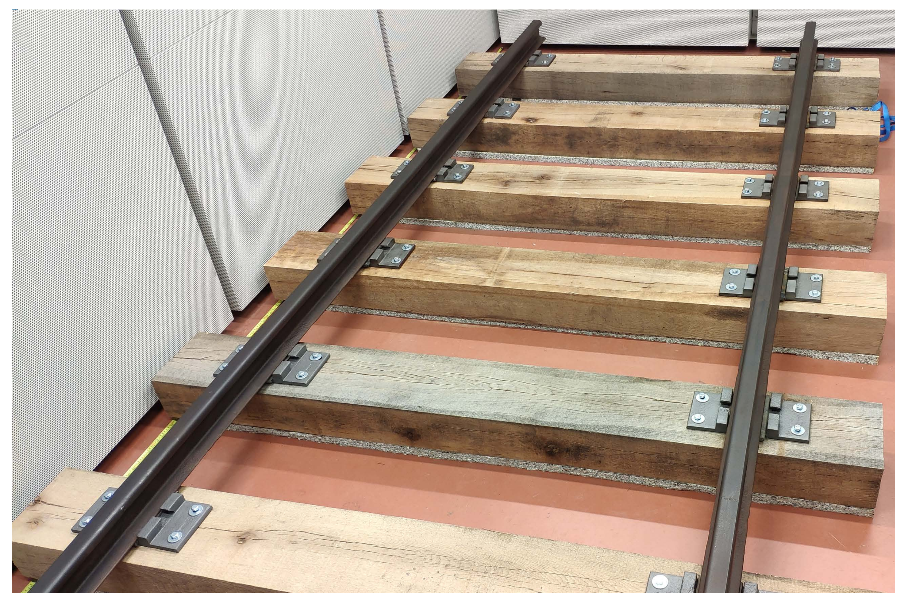
Abbildung 3 Vier Meter Gleisaufbau im Halbfreifeldraum mit Holzschwellen und Rippenplatten
