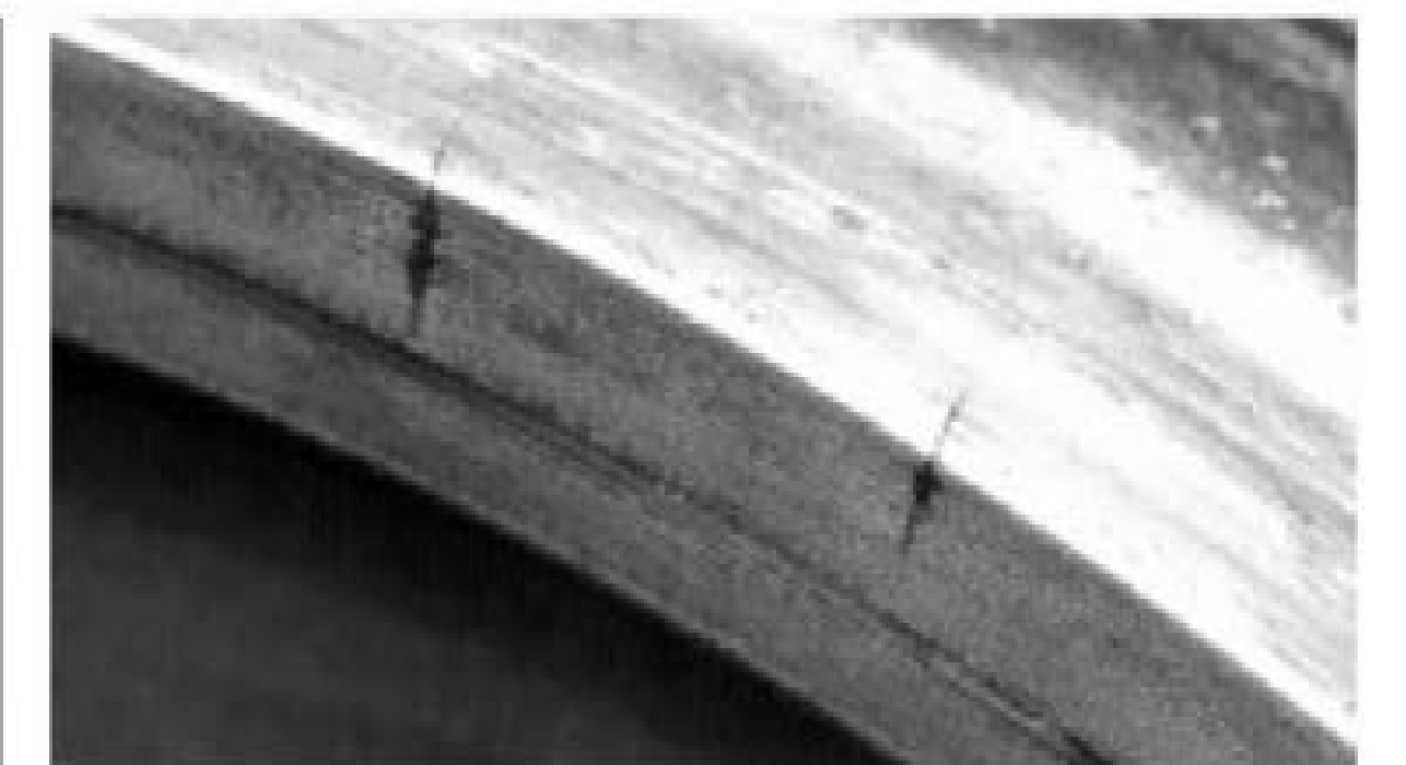
Abbildung 1 Warmrisse an Radreifen im Kontaktbereich der Bremssohle (Quelle: MBQ).
