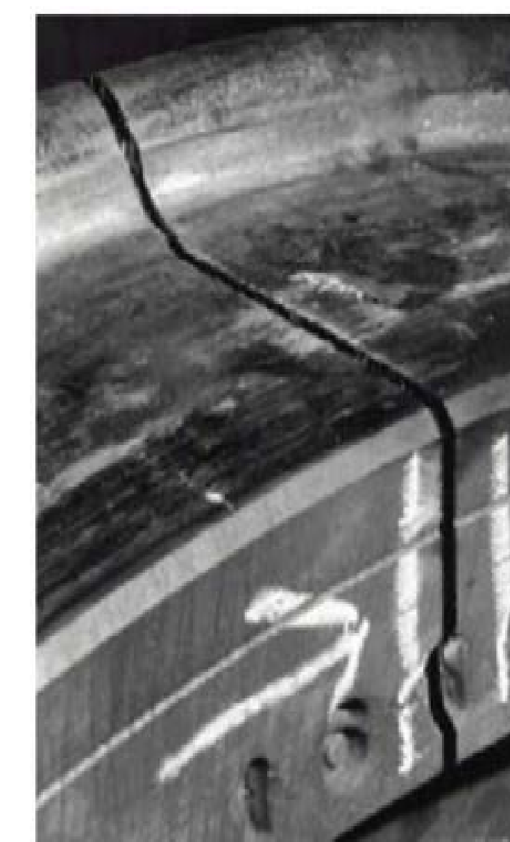
Abbildung 2 Bruch und Risswachstum Warmstempelung (Quelle: MBQ).
