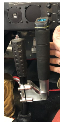
Steuerkraftmesser-prototyp in einem Flugzeug montiert
